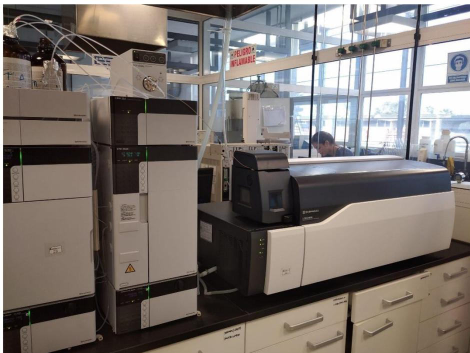
**Figura 13.** Equipo Shimadzu HPLC/UPLC - MS-MS 8045 instalado en el laboratorio Ambiental de DINACEA.
