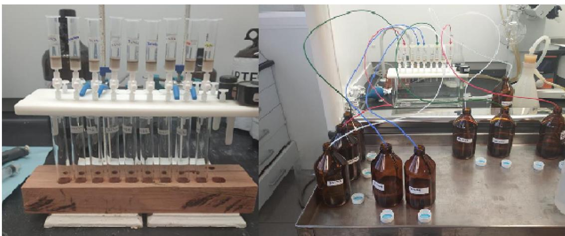
**Figura 12.** Equipamiento para el procesamiento de extracción en fase sólida (SPE) para la matriz agua.
